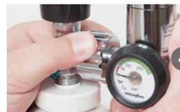
**4 Lösen der Überwurfmutter**
