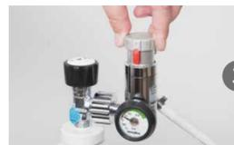
**3 System entlüften.** Öffnen Sie den Inhalationsausgang, indem Sie am Rastkopf einen beliebigen Flowwert > 0 einstellen und lassen Sie den Sauerstoff vollständig abströmen. Bei einem Druckminderer ohne Inhalationsausgang (und somit ohne Rastkopf) entlüften Sie am Beatmungsgerät bzw. MODUL Oxygen oder MODUL CPAP. Dafür schalten Sie das Gerät an und stellen beliebige Werte > 0 ein. Wenn kein abströmender Sauerstoff mehr zu hören ist, ist das System entlüftet.
