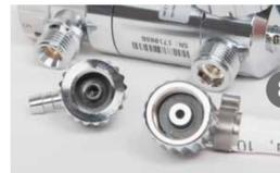
**8 Dichtringe in den Verschraubungen prüfen**
