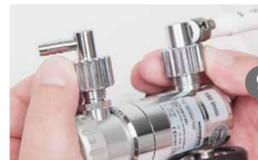
**9 Druckschlauch und Anschlussstülle anschrauben**
