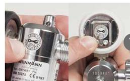
**7 Wartungsaufkleber des OXYWAY-Druckminderers auf Fälligkeit prüfen**
